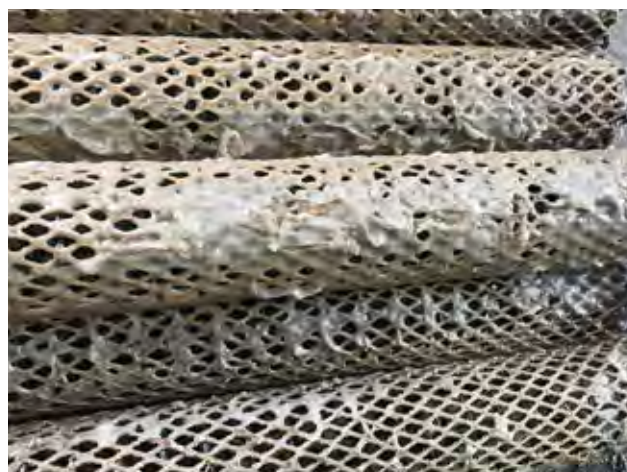
写真2. 充填物に付着したスライム
