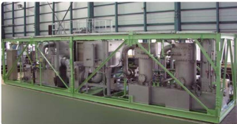
化学兵器処理プラントの排ガス処理システム
